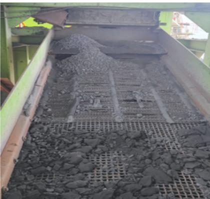
Se cuenta con una criba vibratoria con capacidad de 20 a 80 m<sup>3</sup>/hr a la cual se le instalaron mallas autolimpiantes en la sección inferior de 3/8" y en la sección superior una malla trenzada de 3/4" y se está evaluando una malla autolimpiante de 3/8" complementando la trenzada
