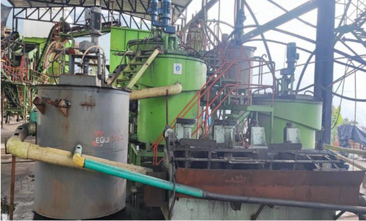
Se instala celda circular #4 y se instalan celdas de flotación rectangulares denver obteniendo buenos resultados con la celda circular, pero con las celdas denver no se observa aumento en las concentraciones
